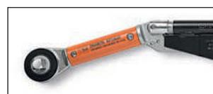
Il meccanismo a disinnesto avvisa l'operatore del raggiungimento della coppia impostata attraverso un piegamento della chiave nel punto dello **snodo di circa 20°**.
